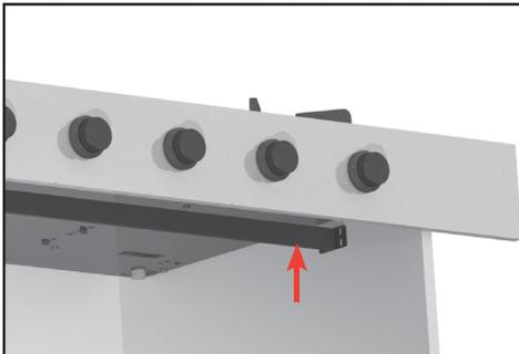
3. Setzen Sie den Stützbalken in den Schrank ein, und positionieren Sie ihn an der Unterseite des PITT® Kocheinheit. **ACHTEN SIE AUF DIE POSITIONIERUNG, SIEHE SCHRITT 4!**
