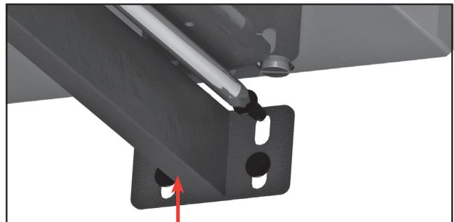
6. Drücken Sie den Stützbalken fest gegen die Unterseite der PITT® Kocheinheit und ziehen Sie erst die oberen beiden Schrauben komplett an und anschließend auch die unteren Schrauben.
