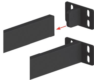
2. Platzieren Sie die Einsatzstücke in die Enden der auf Maß gesägten Stützbalken.
