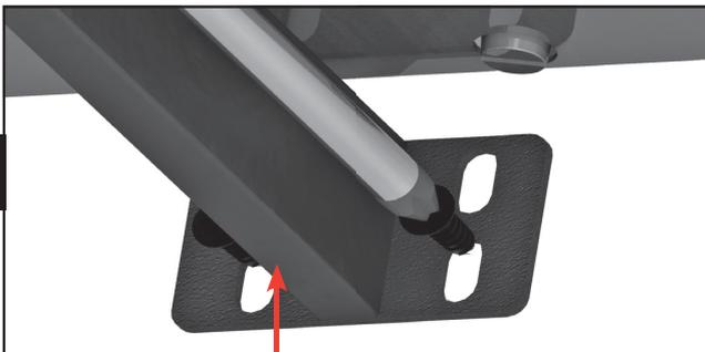
5. Drücken Sie den Stützbalken fest gegen die Unterseite der PITT® Kocheinheit und ziehen Sie die untersten beiden Schrauben handfest an. Wiederholen Sie diesen Schritt auf der anderen Seite des Schrankes.
