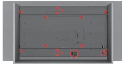
4. Positionieren Sie den Stützbalken so, dass die Stellschrauben, sowie der Gas- und Stromanschluss frei zugänglich sind.
