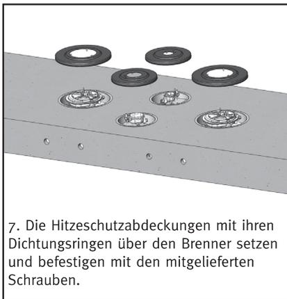
7. Die Hitzeschutzabdeckungen mit ihren Dichtungsringen über den Brenner setzen und befestigen mit den mitgelieferten Schrauben.
