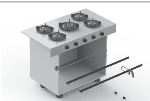
1. Bestimmen Sie die Abmessungen des Schrankes und sägen Sie die Stützbalken ab. **ACHTUNG! Richtige Balkenlänge = Maß Schrankinnenseite - 4 mm.**
