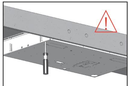
12. Ziehen Sie die Stellschrauben von hinten nach vorne an, bis sich die Gasregler im Zentrum der Aussparungen befinden. Überprüfen Sie, ob alle Schrauben **angezogen** sind.
