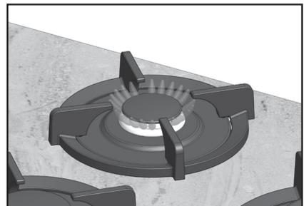
18. Schließ das Gerät an zu Gas und strom und zünd die Brenner. Wenn die **Flammen** nach der Zündung **löschen überprüf den Knopf in Schritt 9 wieder**.
