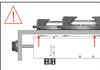
19. Überprüfen Sie, ob der Wärmeleiter vollständig mit der Arbeitsplatte in Kontakt ist.
