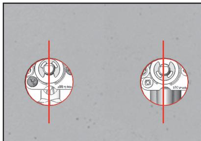
11. Bringen Sie die Einheit vorsichtig in Position, bis die Gasregler vertikal mit den Aussparungen in der Frontleiste (oder Blende) ausgerichtet sind.
