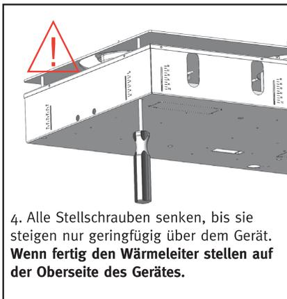
4. Alle Stellschrauben senken, bis sie steigen nur geringfügig über dem Gerät. **Wenn fertig den Wärmeleiter stellen auf der Oberseite des Gerätes.**
