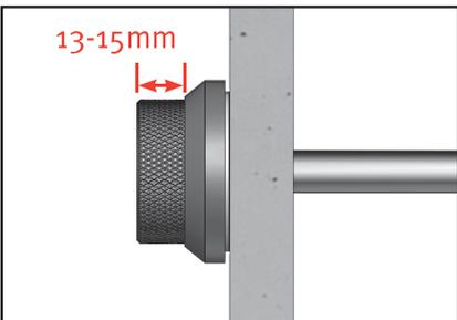
16. Überprüfen Sie, ob der Drehknopf weit genug herausragt. Die Drehknöpfe müssen 13-15 mm über die Dichtungschalen herausragen.
