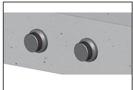
15. Entfernen die Schutzfolie von der Dichtmanschette und drück den Knopf und Dichtmanschette als Ganzes. Die punkten ausgerichtet und konzentrisch.
